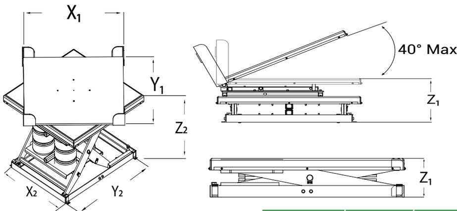
*El sistema de aire cautivo elimina la necesidad de conexiones de aire constantes o resortes mecánicos engorrosos.*
